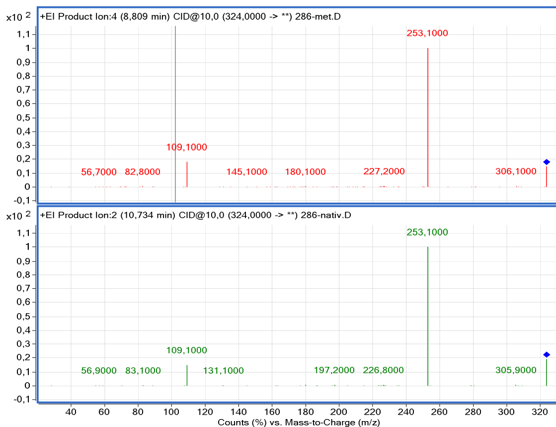
Рис. 4. Вторичные масс-спектры иона 324 для метилового эфира М1 (сверху) и нативного каннабимиметика АВ-FUBINACA (снизу) при энергии соударений 10 Эв
