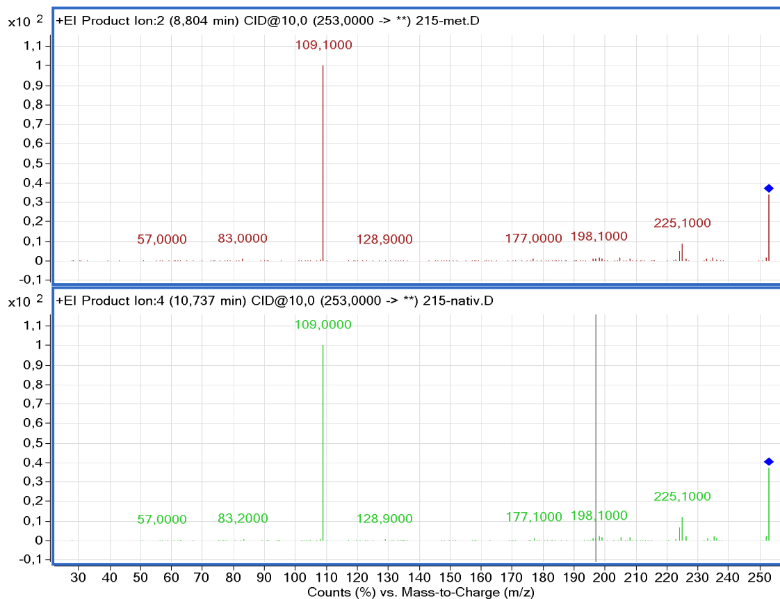
Рис. 5. Вторичные масс-спектры иона 253 для метилового эфира М1 (сверху) и нативного каннабимиметика АВ-FUBINACA (снизу) при энергии соударений 10 Эв
